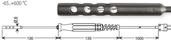
für Raumtemperatur, Rauchgase, etc.; gelochtes V4A-Schutzrohr, dahinter
