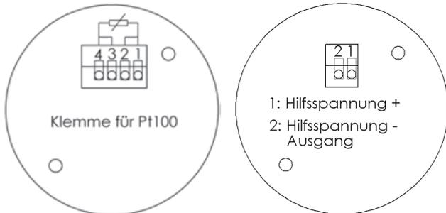
Bei elektr. Anschluss: Kabelanschluss M12-Stecker
