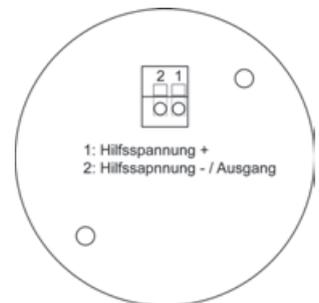
Bei elektr. Anschluss: Kabelanschluss M12-Stecker
