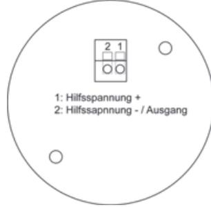
Bei elektr. Anschluss: Kabelanschluss M12-Stecker
