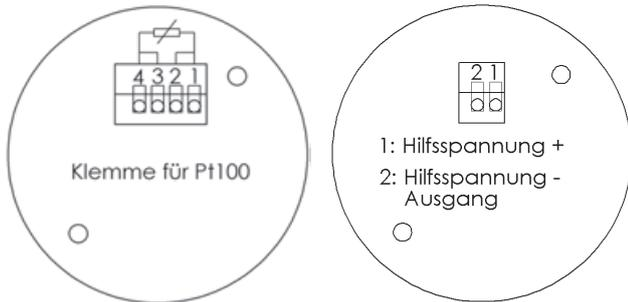
Bei elektr. Anschluss: Kabelanschluss M12-Stecker
